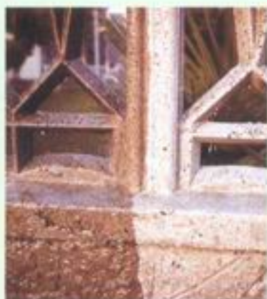
Struttura cementizia trattata e non sotto l'acqua
