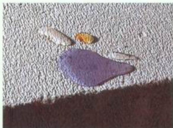
Esempio di idrorepellenza su superficie di materiale trattato con ACQUABLOC
