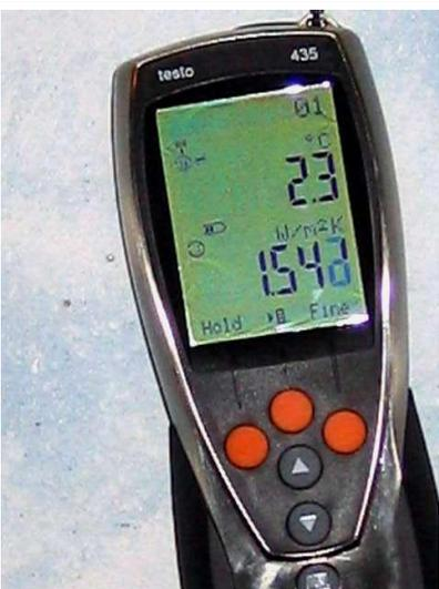
Sullo strumento è possibile verificare la Temp. esterna di 2.3°C misurata da sonda esterna Wireless, la Temperatura interna si è sempre aggirata mediamente tra i 18.5 e 21.5°C. durante tutto il periodo. Per la maggior parte del tempo il  $\Delta T$  è stato superiore ai 15°C come richiesto dalla norma ISO 9869
