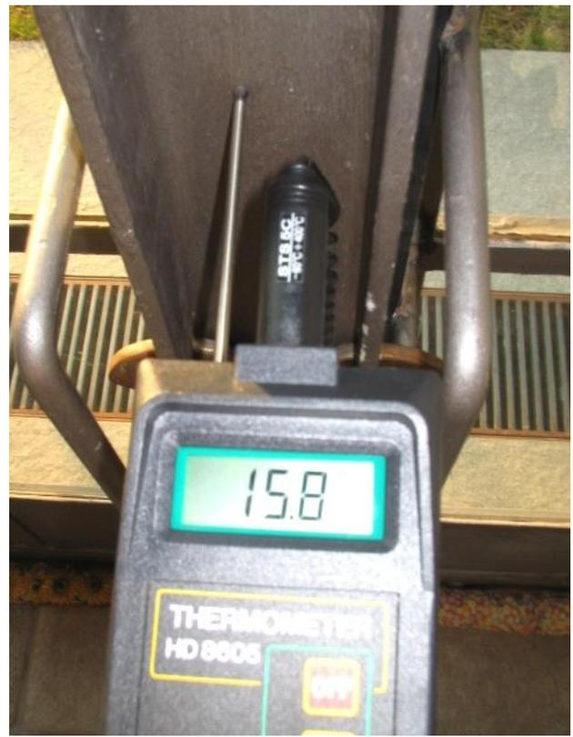
**Temperatura interna dei profili e putrelle misurate in tempi ravvicinati.**
